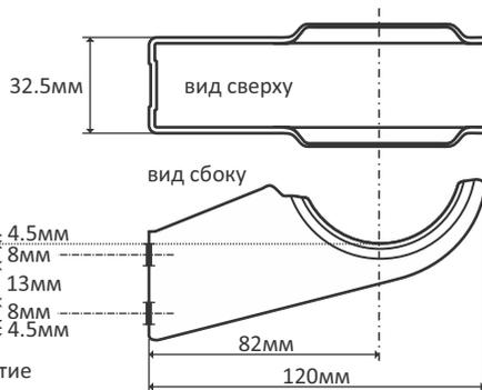
Рисунок 4.2 - Кронштейн 120мм для 3-х трубчатых радиаторов
